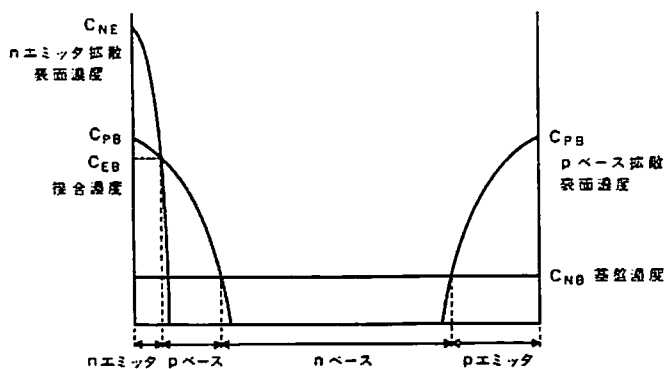
図5-4 サイリスタの不純物拡散プロファイル
